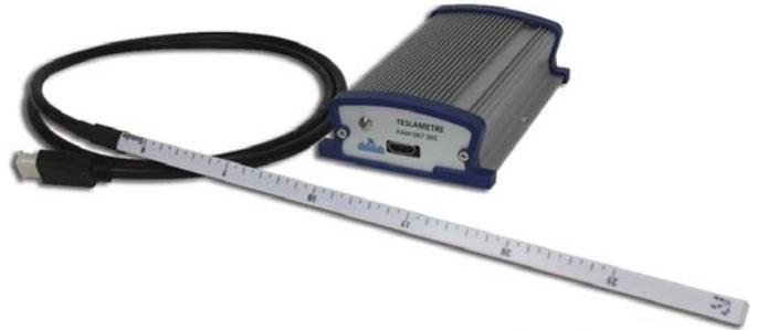
Le Teslamètre est composé d'un boîtier et d'une sonde triaxiale graduée permettant la mesure selon 3 axes  $B_x$ ,  $B_y$  et  $B_z$  grâce à 3 capteurs à effet de Hall.
