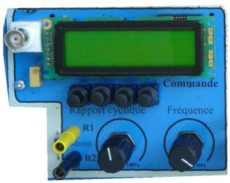
La partie commande génère les signaux de commande des thyristors, ainsi qu'une interface homme machine (IHM), permettant :
