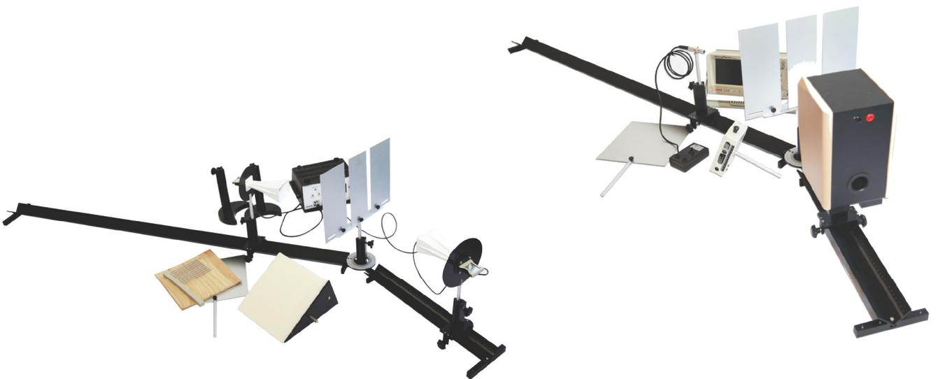
Avec son système de serrage en deux points et son guidage en V, le cavalier est stable et supporte facilement lanterne ou onde centimétrique. La lecture de la graduation se fait sur l'intérieur du banc par différence en repérant la graduation sur le bord du cavalier.
