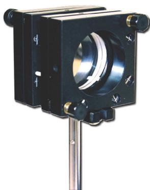
Ensemble de Miroirs polis à  $\lambda/10$  en diamètre 50,8 mm, monté sur monture réglable 3 points (1 point fixe, 2 réglables). La cavité de cet étalon est fixe. Vous pouvez néanmoins choisir de modifier celle-ci avant expérience avec une clé à 6 pans. 3 butées en nylon empêchent tout contact entre les deux miroirs d'un coefficient de réflexion supérieur à 0,9.
