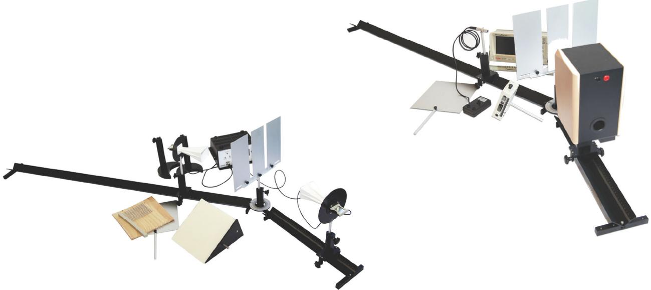
Avec son système de serrage en deux points et son guidage en V, le cavalier est stable et supporte facilement lanterne ou onde centimétrique. La lecture de la graduation se fait sur l'intérieur du banc par différence en repérant la graduation sur le bord du cavalier.
