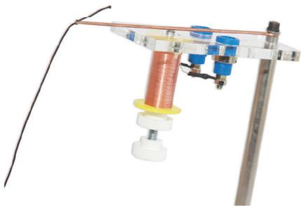
Appareil destiné à générer des ondes mécaniques à partir d'un signal basse fréquence.
