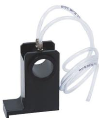
Pied muni d'une butée d'arrêt pour faciliter le positionnement de la cuve sur la platine de l'interféromètre de Michelson.
