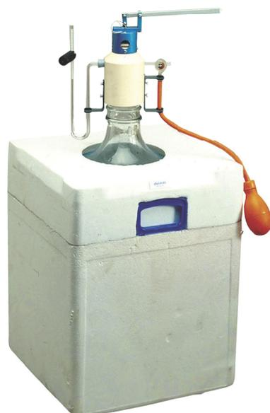
Un grand récipient rempli d'air à une pression un peu supérieure à la pression atmosphérique est ouvert pendant un court instant. Le gaz se détend jusqu'à la pression atmosphérique en une détente pratiquement adiabatique et il se refroidit. Puis, le gaz se réchauffe jusqu'à la température initiale (température ambiante) et la pression augmente.
