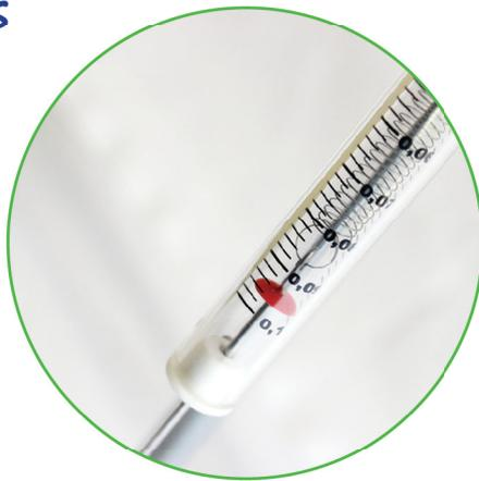
Avec les dynamomètres de 0,1 N et 0,2 N, vous serez capables de mesurer la valeur de la tension superficielle d'une multitude de fluides ayant une tension superficielle plus ou moins élevées : eau, eau salée, eau chaude, eau savonneuse, huile, alcool ... L'idée étant pour les élèves de constater les différences de précision de la mise en œuvre de leur protocole de test.
