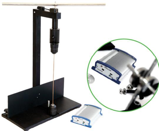
Un solide de forme géométrique simple (disque, barre), dont il est facile de calculer le moment d'inertie par rapport à un axe, est fixé à l'extrémité du fil de torsion vertical. On fait osciller le solide et on relève sa période  $T$  grâce au logiciel fourni.
