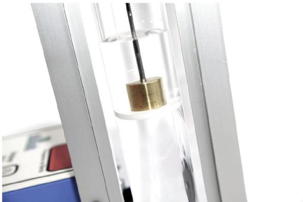
On remplit la burette d'eau et on ajuste si besoin la hauteur du système pour que la masse reste tout le temps dans l'eau au cours du mouvement. On fixe la masse de plus petit diamètre au ressort, et on écarte la masse verticalement de sa position d'équilibre de 2 ou 3 cm. On lâche le système et on mesure la période d'oscillation du système. On pourra refaire l'expérience avec une autre masse ou un fluide différent.
