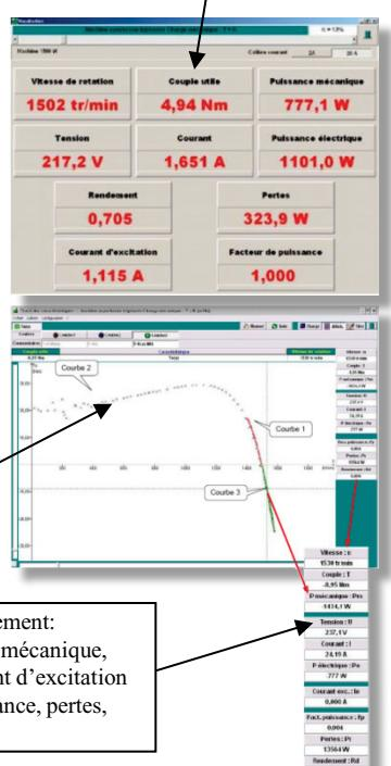
Résultat d'un essai sur asynchrone triphasé à cage :
