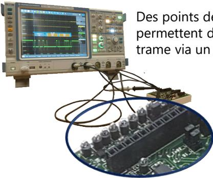
Des points de test permettent de lire la trame via un oscilloscope
