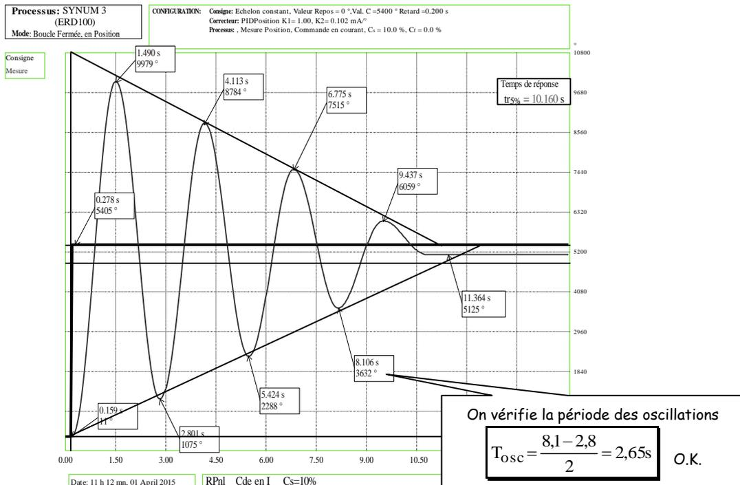
E4. Le temps de réponse à 5%:  $t_{r5\%} = 1,5 \text{ S} \rightarrow$  Proche des prédéterminations
