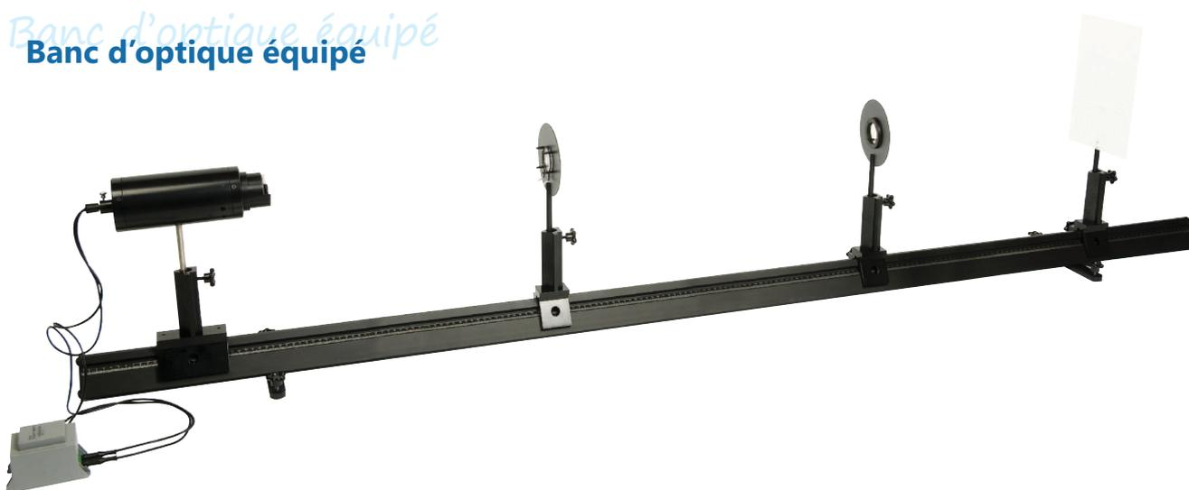
Banc d'optique prismatique de 2 mètres équipé.
