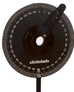
Les lames à retard ont des vitesses de propagation de l'onde lumineuse différentes en fonction de leur orientation.
