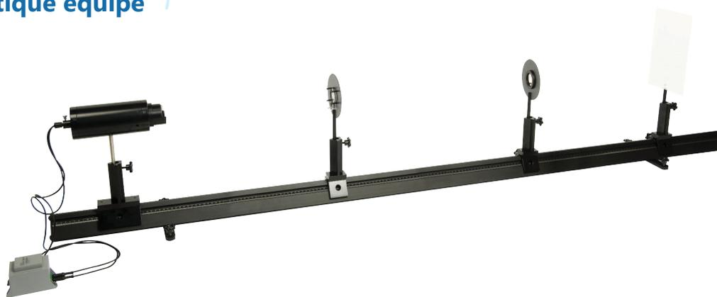
Banc d'optique prismatique de 2 mètres équipé.
