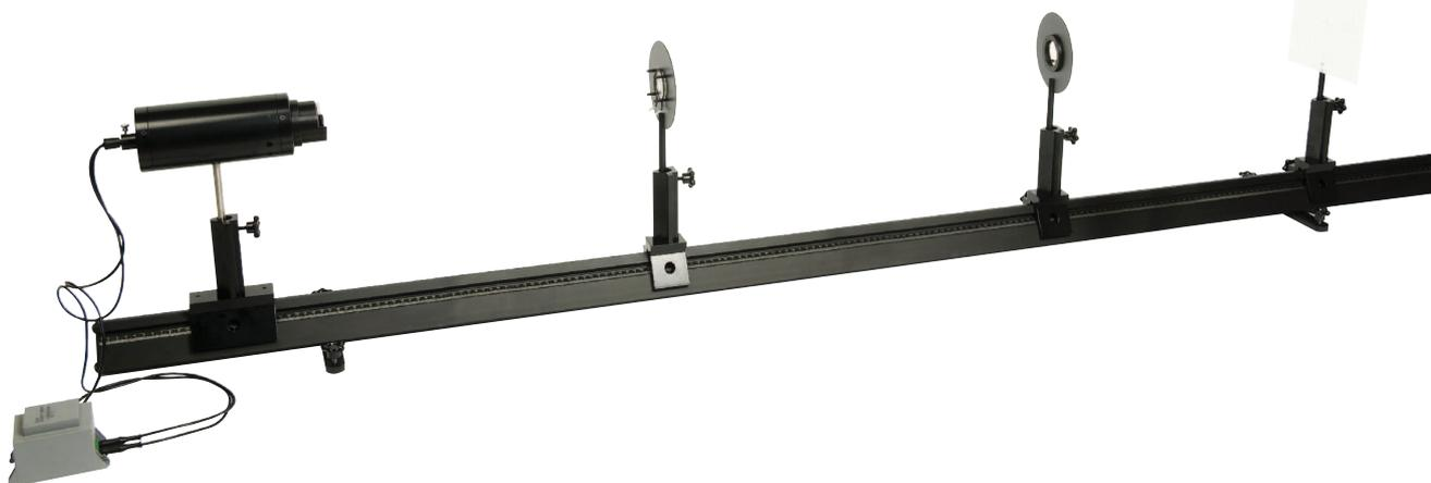
Banc d'optique prismatique de 2 mètres équipé.
