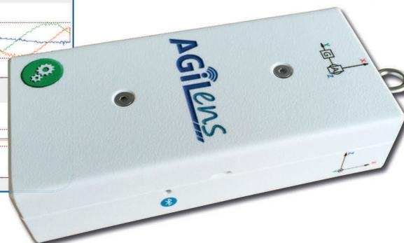
L'accéléromètre et gyroscope ITAC pour l'enseignement est la résultante d'une fusion d'un accéléromètre, d'un gyroscope et d'un système de communication sans fil Bluetooth. Ces technologies, utilisées désormais dans notre quotidien, s'assemblent pour fournir un produit cohérent, adapté et adaptable aux nouvelles pédagogies.
