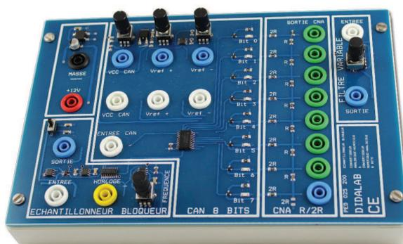
Ce module illustre les principes de la conversion numérique analogique par réseau R/2R et de la conversion analogique numérique par échantillonneur Bloqueur. Il vous permet entre autre :
