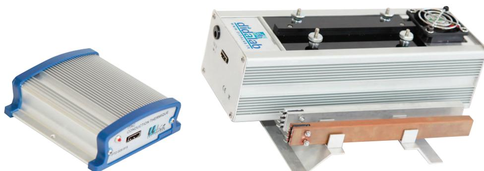
Appareil permettant de démontrer la loi fondamentale qui lie le flux calorifique au gradient de température et à la surface traversée par le flux. Mesure de la conduction des métaux.
