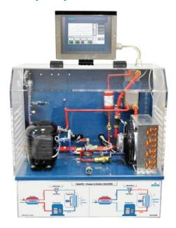
Banc homothétique d'applications de chauffage d'origine ENR (aérothermique) avec fonctions ECS et chauffage (réversibilité en option).
