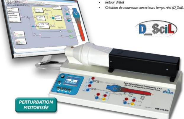
Pack ERD 540 C: Pack complet « Etude d'une régulation de débit et température d'air »
