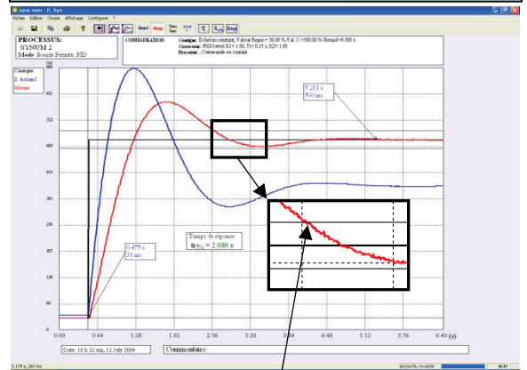
mesure automatique du temps de réponse à 5% sur le signal de mesure, image de la vitesse
