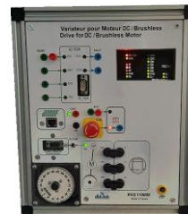
EST110P : Cube variateur PDC 100 avec Moteur CC 24V
