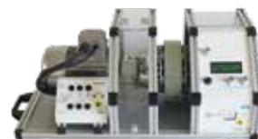
**ELS 326 B :** BICSIN, Banc de charge 300 W, avec charge émulée par moteur Brushless accouplé à un deuxième moteur Brushless TBTS.
