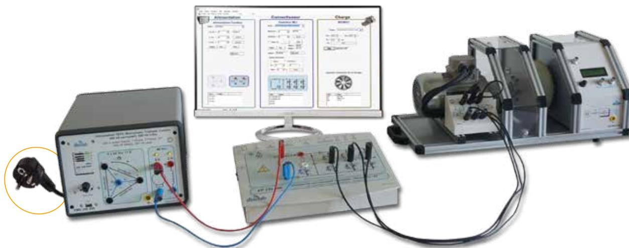
**EL(S) 31\_B - BICMAC (S) 300** : Banc Instrumenté de Charge Moteurs Alternatifs et Continus 300W
