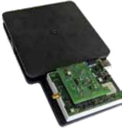
Montage mécanique et électronique de la balance connectée
