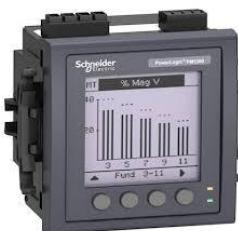
**La centrale de mesure électrique** est un dispositif ou un système conçu pour mesurer différents paramètres électriques dans un réseau ou une installation électrique. Elle permet de surveiller, d'analyser et de contrôler les diverses grandeurs électriques comme la tension, le courant, la puissance, la fréquence, l'énergie consommée, etc. Ces mesures sont essentielles pour assurer le bon fonctionnement et la sécurité des installations électriques.
